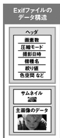
図5 Exifファイルのデータ構造
